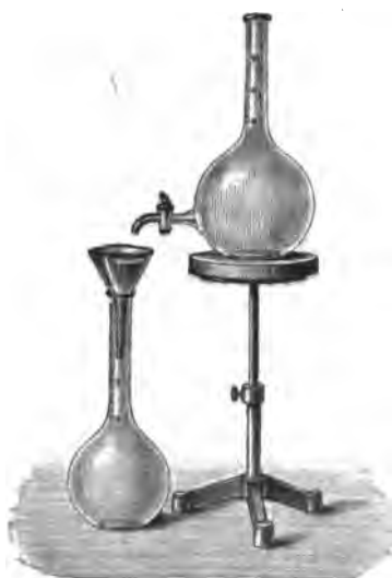
Fig. 8. — Ballon à robinet pour le dosage rapide de la magnésie.
